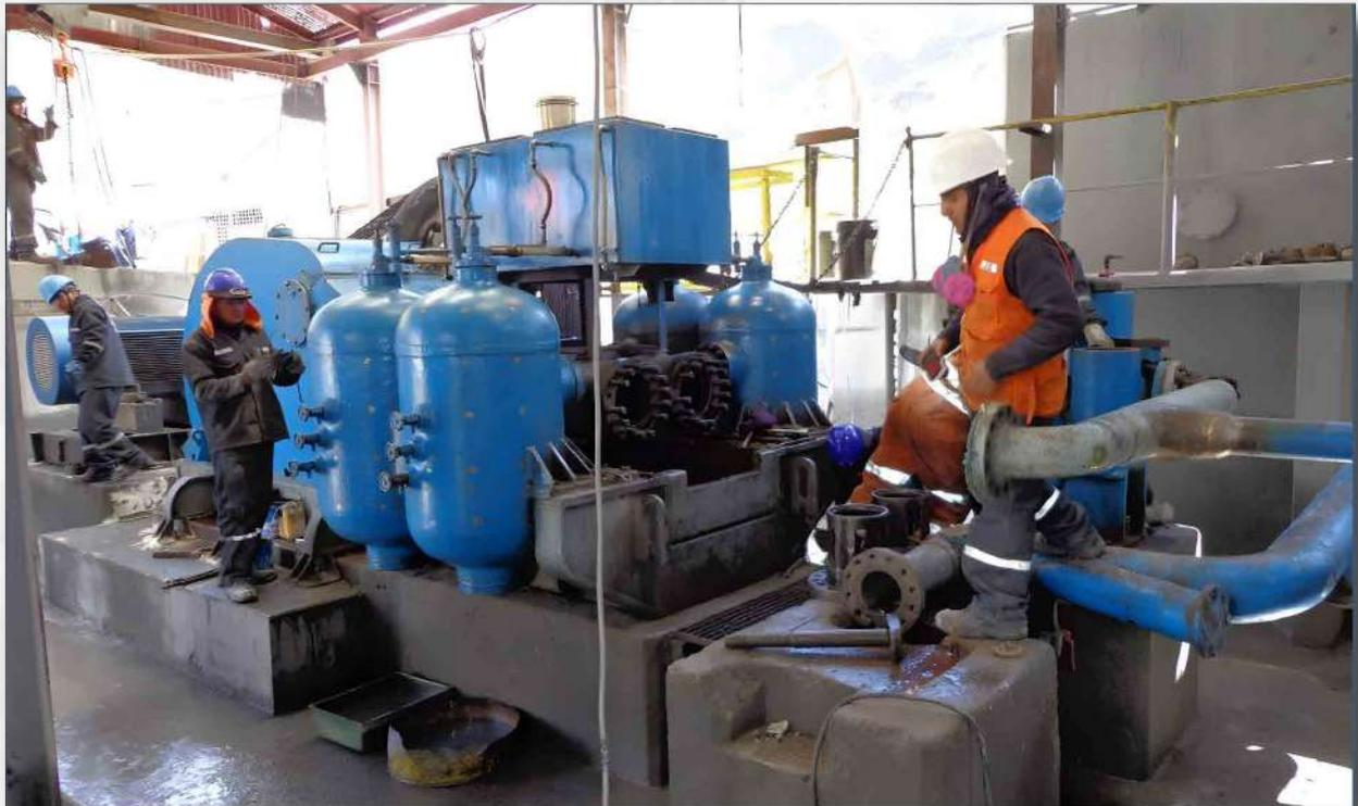
**MANTENIMIENTO PARA BOMBA MARS S180**
