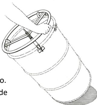
El volante está construido con tubos estructurales de acero según IRAM 228 vinculados entre sí mediante soldadura. El exterior cuenta con un acabado de pintura epoxi.
