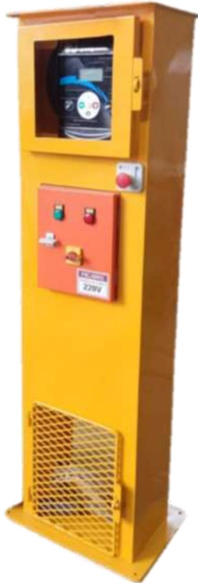
Se ensambla el pedestal de control con plancha de acero de 1/8", cuyas dimensiones son las siguientes: 0.40mx0.25mx1.55m, la base es plancha metálica 1/4".
