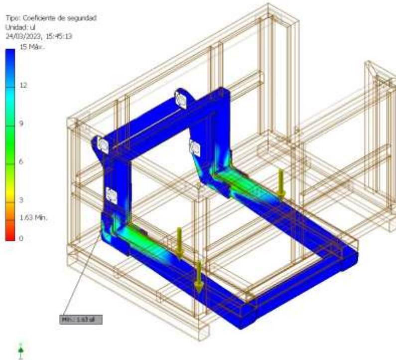
El coeficiente de seguridad en la parte más débil en la estructura de la base principal con una carga de 2,272 kg es de 1.63
