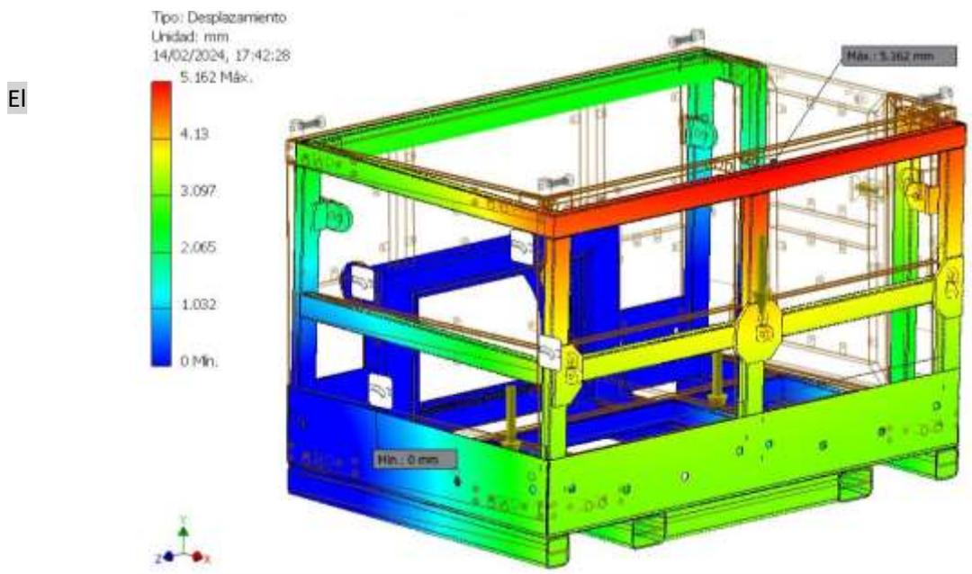
desplazamiento o deformación máxima en la estructura de la base principal aplicando 2,323 kg es de 5.162 mm
