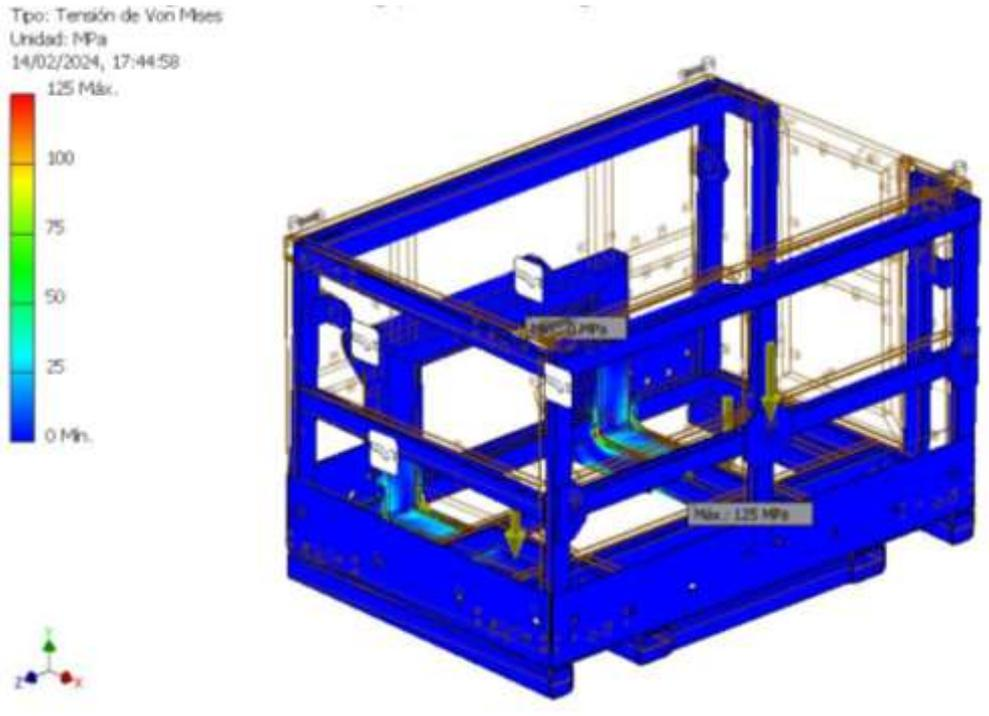
El esfuerzo máximo en la parte más débil en la estructura de la base principal con una carga aplicada de 2,323kg es de 125 Mpa.
