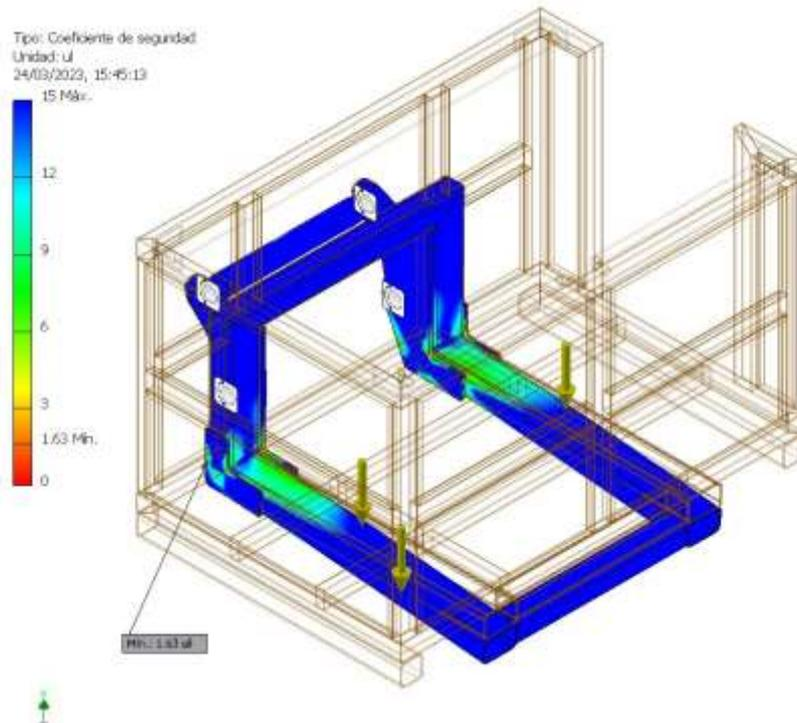
El coeficiente de seguridad en la parte más débil en la estructura de la base principal con una carga de 2,323 kg es de 1.63
