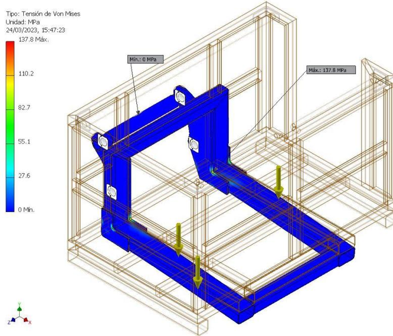
El esfuerzo máximo en la parte más débil en la estructura de la base principal con una carga aplicada de 2,151 kg es de 137.8 Mpa.
