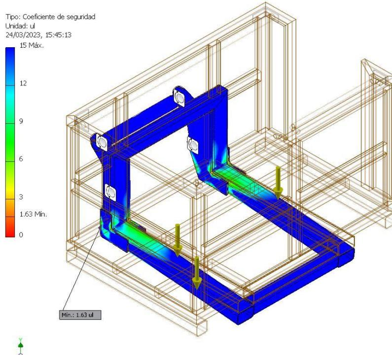
El coeficiente de seguridad en la parte más débil en la estructura de la base principal con una carga de 2,151 kg es de 1.63
