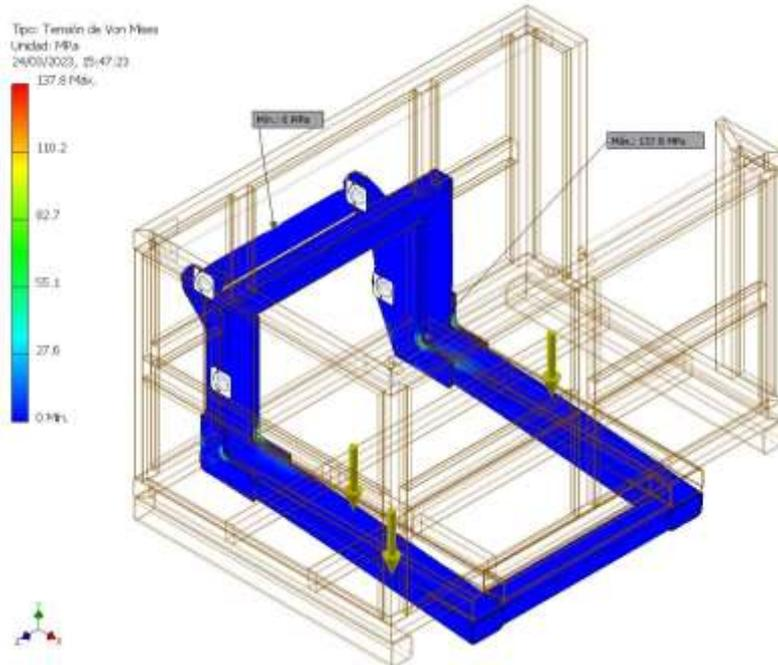
El esfuerzo máximo en la parte más débil en la estructura de la base principal con una carga aplicada de 2,477kg es de 137.8 Mpa.
