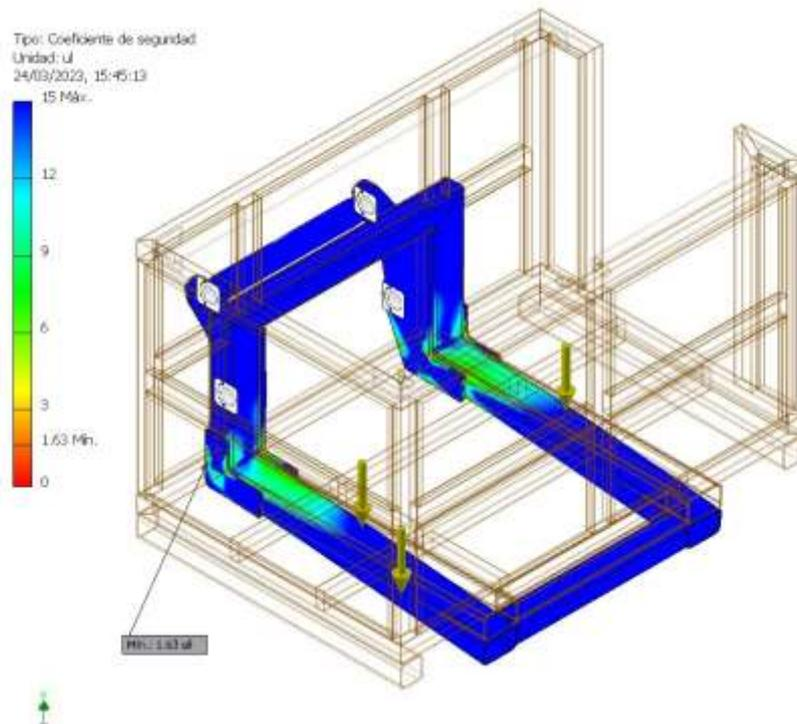
El coeficiente de seguridad en la parte más débil en la estructura de la base principal con una carga de 2,477 kg es de 1.63
