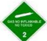
Clasificación según SGA: Gases a presión - Gas comprimido, H280: Contiene gas a presión; peligro de explosión en caso de calentamiento.
