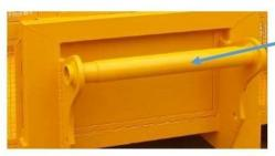
ANCLAJE PRINCIPAL: Modelo TIPO 2, consta de tubo reforzado para anclaje a equipo Manitou.
