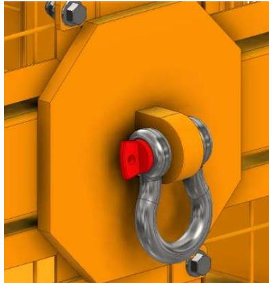
Para **validar una capacidad de 300 Kg** en el alojamiento de un cáncamo, se aplica 1.6 como factor a 300KgF, generando la simulación con 480 kg (300 kg x 1.6) y se aplica una carga interna de 1600 Kg (1000Kg de capacidad x 1.6 factor) simulando condiciones extremas de operación.
