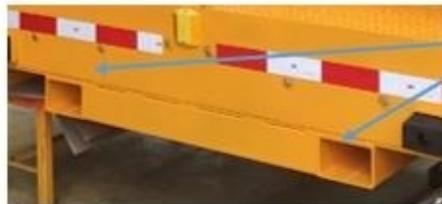
**ORQUILLAS:** Alojamiento para el ingreso de uñas del equipo Manitou para levantamiento de la
