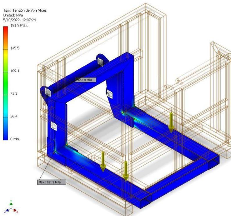
El esfuerzo máximo en la parte más débil en la estructura de la base principal con una carga aplicada de 2,278 kg es de 181.9 Mpa.
