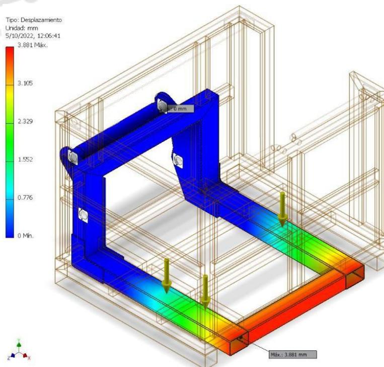
El desplazamiento o deformación máxima en la estructura de la base principal aplicado 2,278 kg es de 3.88 mm
