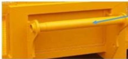
**ANCLAJE PRINCIPAL:** Modelo TIPO 2, consta de tubo reforzado para anclaje a equipo Manitou.
