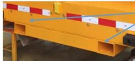
**ORQUILLAS:** Alojamiento para el ingreso de uñas del equipo Manitou para levantamiento de la
