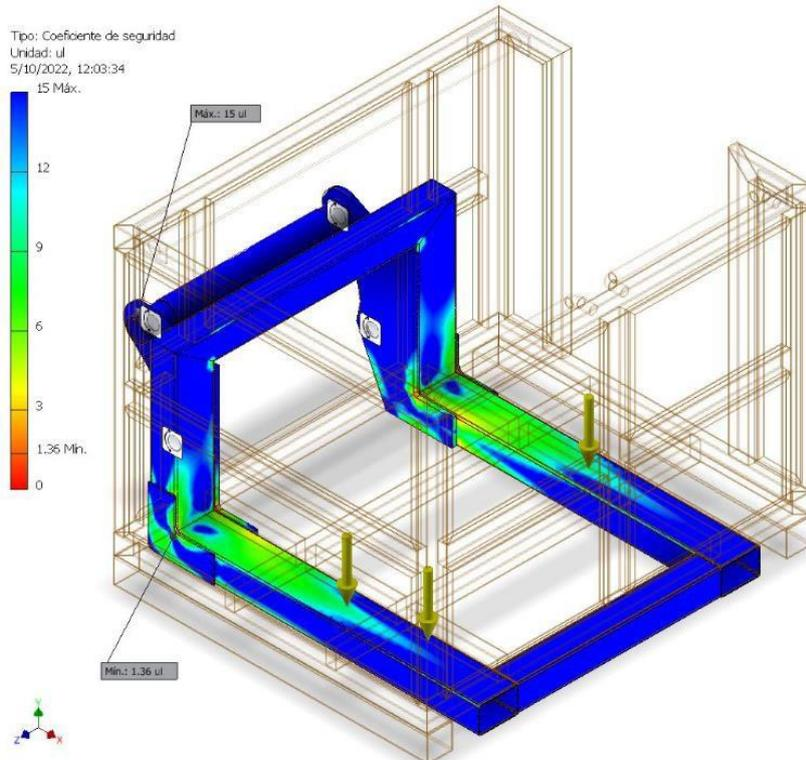
El coeficiente de seguridad en la parte mas debil en la estructura de la base principal con una carga de 2,278kg es de 1.36; esto representa en la base principal, una capacidad de Carga de 1000Kg
