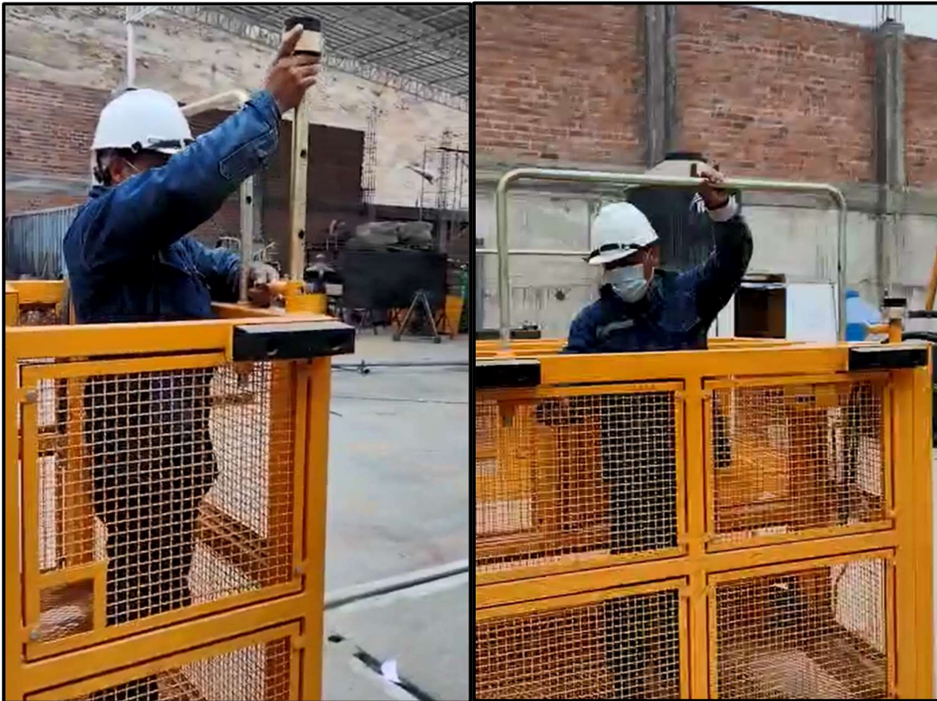
Fig. 02. Activación de parante y baranda de seguridad
