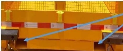
**ORQUILLAS:** Alojamiento para el ingreso de uñas del equipo Manitou para levantamiento de la
