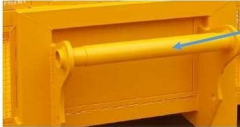
**ANCLAJE PRINCIPAL:** Modelo TIPO 2, consta de tubo reforzado para anclaje a equipo Manitou.
